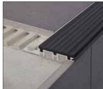
Schlüter-TREP-S/-B представляет собой сделанный из нержавеющей стали или алюминия профиль для лестниц, оснащенный зажатым сменным вкладышем из противоскользящей пластмассы. Ширина вкладыша в изделиях TREP-S и -S-E составляет 26 мм, а в изделии TREP-B - 52 мм. Профили также пригодны для объектов с повышенной нагрузкой.
