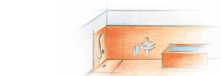
Места около душа, за умывальником и около ванн считаются мокрыми зонами, которые особенно сильно подвержены воздействию влаги. С помощью комбинированной гидроизоляции Schlüter-KERDI они могут быть рациональным образом защищены от проникновения влаги.
