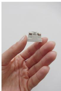
3. Sostituire il fusibile difettoso con un fusibile G 5 x 20 mm.
