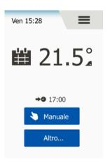
Il termostato vi consente di controllare la temperatura automaticamente in base ad un programma settimanale scelto da voi. Il termostato viene fornito con una serie di orari già programmati adatta ad un controllo semplice ed economico del riscaldamento nella maggior parte delle abitazioni, vedi "Impostazioni di fabbrica: Programma preimpostato".
