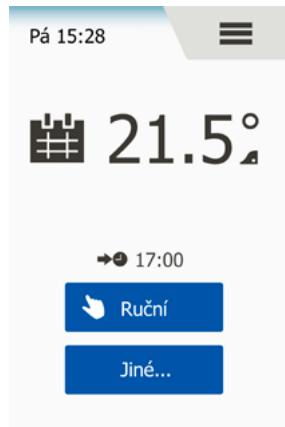
Termostat umožňuje automaticky regulovat teplotu podle týdenního časového plánu, který vyberete. Termostat se dodává s předem naprogramovaným časovým plánem pro snadnou a ekonomickou regulaci topení ve většině domácností, viz Tovární nastavení: Přednastavený časový plán.
