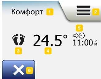
Во время работы терmostата в режиме Комфорта на Исходном дисплее отображается кнопка “X”. Нажмите эту кнопку для возврата термостата в автоматический режим работы по установленному графику.
