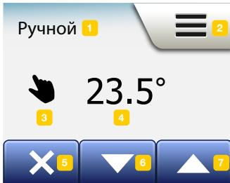
В ручном режиме существует возможность деактивировать работу термостата по установленному графику и поддерживать какое-то время специально заданную температуру.
