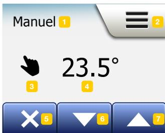
La fonction "Manuel" vous permet de contourner le fonctionnement planifié et de maintenir une température spécifique 24 heures sur 24.
