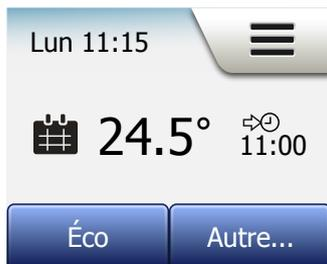
La fonction éco réduit la quantité d'énergie utilisée pour du chauffage non requis si vous êtes absent d'une pièce/de la maison pendant un événement de chauffage planifié.
