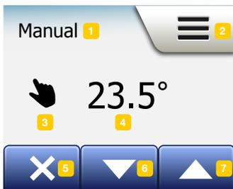
El modo Manual le permite anular el Funcionamiento programado y mantener una temperatura especificada las 24 horas el día.
