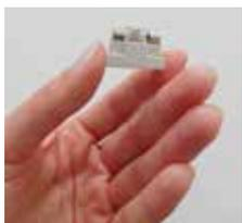
3. Cambie el fusible defectuoso por un fusible G de 5 x 20 mm.
