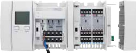
5. Setzen Sie die Abschlussklappe auf das letzte Anschlussmodul / Anschlussmodul WL.
