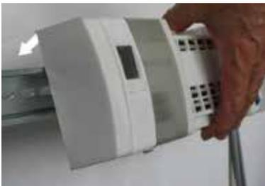
1. Setzen Sie die Module mit den oberen Haken in die Hutschiene ein.
