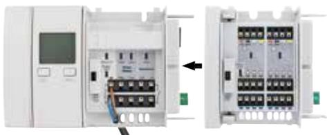
3. Verbinden Sie das/die Anschlussmodul(e) WL/ Anschlussmodul(e) mit dem Basismodul Control.
