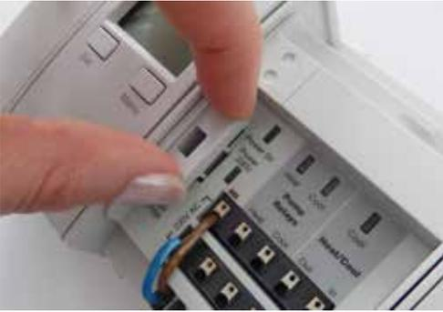
4. Setzen Sie den Sicherungshalter in das Sicherungsfach.
