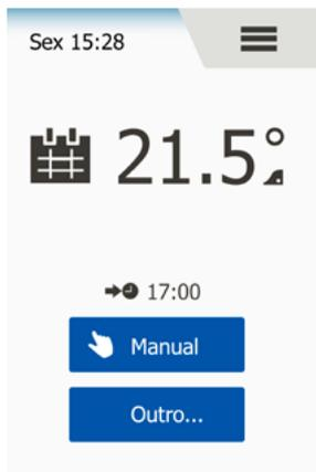
O termóstato permite controlar automaticamente a temperatura, de acordo com um programa semanal definido pelo utilizador. O termóstato é fornecido de fábrica com um programa pré-definido para um controlo de aquecimento fácil e económico, que pode ser adequado para a maior parte das habitações; ver o capítulo “Configurações de Fábrica: Programa Pré-Definido”.
