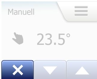
„Abbrechen“ wird auf dem Bildschirm als eine mit „X“ markierte Taste angezeigt.
